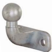
Crochet coudé boule Ø 50 mm 2 trous. Ø 17 mm x entraxe 90 mm. 1,9 kg.
